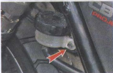
17. Шестигранным ключом на 5 мм отворачиваем два болта крепления тормозного цилиндра.
