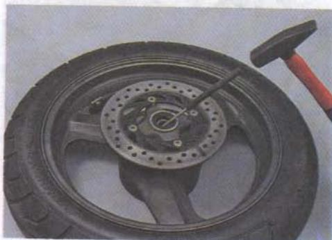
5. При помощи оправки или инструментальной головки подходящего диаметра выпрессовываем подшипник опорного диска ведомой звездочки.
