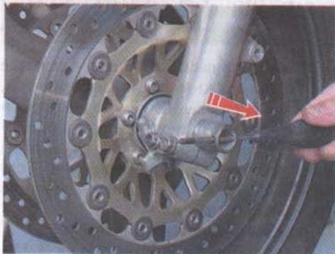
4. Вынув ось, сдвигаем колесо вперед и вниз, одновременно извлекая из пыльника ступицы колеса распорную втулку.
