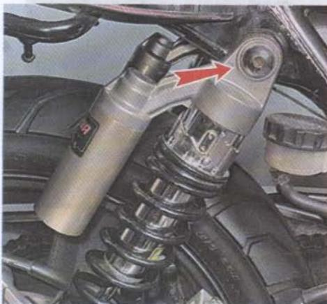
2. Удерживая внутреннюю гайку нижнего болта ключом на 17 мм, отворачиваем болт ключом на 14 мм и извлекаем его.
