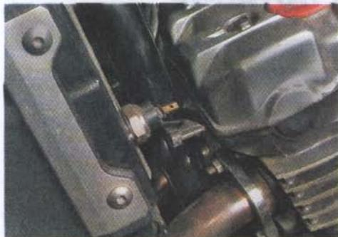
3. Извлекаем датчик и проверяем целостность резинового уплотнительного кольца. При необходимости заменяем кольцо.
