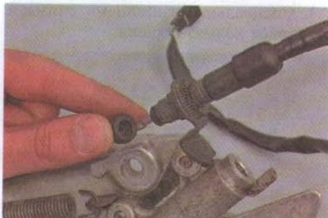
3. Ослабляем затяжку гайки и отворачиваем датчик от кронштейна крепления.
