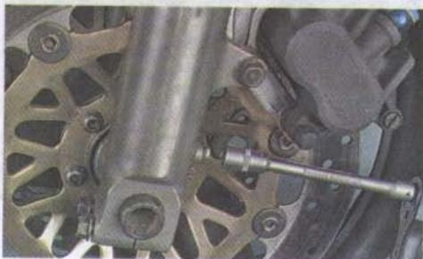
2. Ключом на **17 мм** отворачиваем верхнюю гайку (наконечник) пера вилки и даем маслу полностью стечь.
