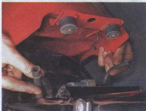
5. Разжав пружинные хомуты, отсоединяем от топливного крана трубку подачи бензина и вакуумную трубку.
