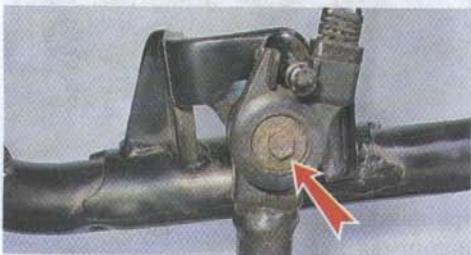
3. Ключом на 14 мм отворачиваем гайку болта крепления бокового упора.
