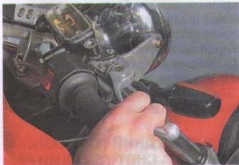
4. Ослабляем прокачной штуцер, отвернув его ключом на 8 мм на 0,5–1,5 оборота. При этом рычаг начинает перемещаться, вытесняя тормозную жидкость через шланг.
