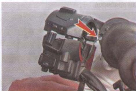
13. Ключом на 12 мм отворачиваем гайку оболочки троса пускового обогатителя.
