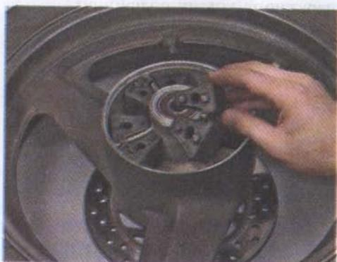
3. Очищаем от грязи и осматриваем демпфирующие элементы на отсутствие выработки, трещин и деформаций.
