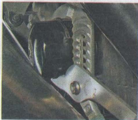
11. Заворачиваем и затягиваем сливную пробку моментом 34 Н·м.
