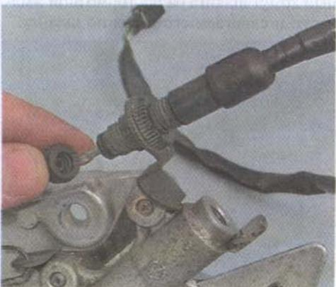
13. Вращая регулировочное кольцо, выворачиваем датчик и снимаем его.
