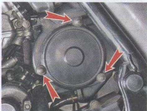
3. Снимаем крышку и извлекаем фильтрующий элемент.
