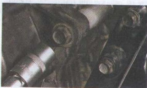
11. Извлекаем дистанционные втулки, после чего ключом на 14 мм отворачиваем болты крепления передних кронштейнов двигателя и снимаем их.
