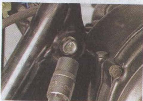
8. Для извлечения верхней шпильки можно воспользоваться выколоткой подходящего размера. Легкими ударами молотка извлекаем шпильку из втулок. Силовой агрегат осядет задней частью на раму.
