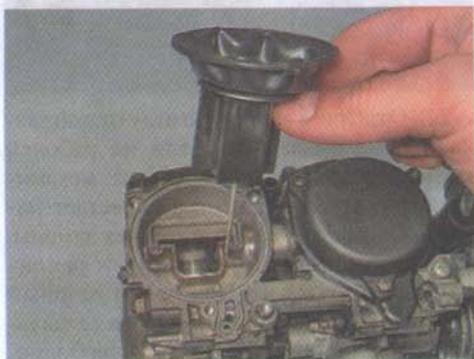
14. Осматриваем мембрану. Если на ней заметны трещины, отверстия, надрывы, прочие механические повреждения, резина покороблена или затвердела, мембрана в сборе с дроссельной заслонкой подлежит замене.
