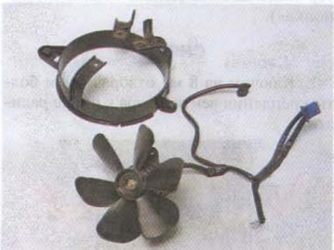
4. Ключом на 7 мм отворачиваем гайку крепления крыльчатки.
