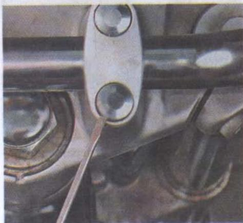
2. Шестигранным ключом на 6 мм отворачиваем четыре болта стоек руля.
