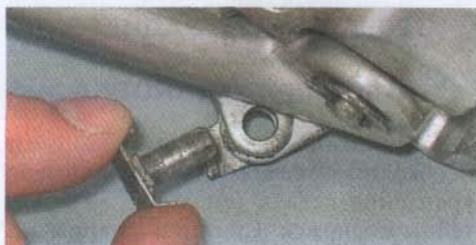
5. Специальными щипцами снимаем стопорное кольцо оси педали.
