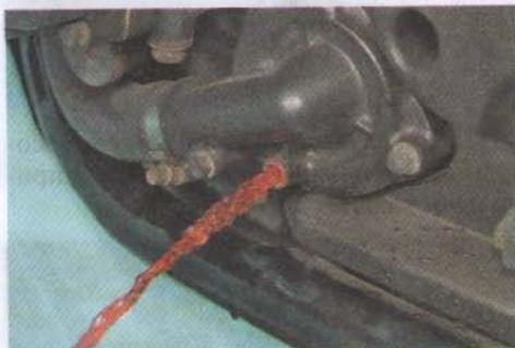
8. Поочередно ключом на 10 мм ослабляем затяжку левой и правой сливных пробок на блоке цилиндров. Подставив емкость, сливаем охлаждающую жидкость из рубашки охлаждения цилиндров.
