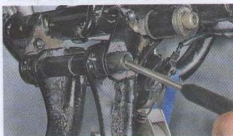
7. Извлекаем ось подставки и снимаем подставку, сдвигая ее вниз и вперед.
