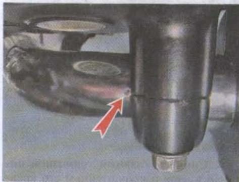
4. При сборке крепления тормозных шлангов устанавливаем новые медные или алюминиевые уплотнительные шайбы (на фото отмечены стрелками).
