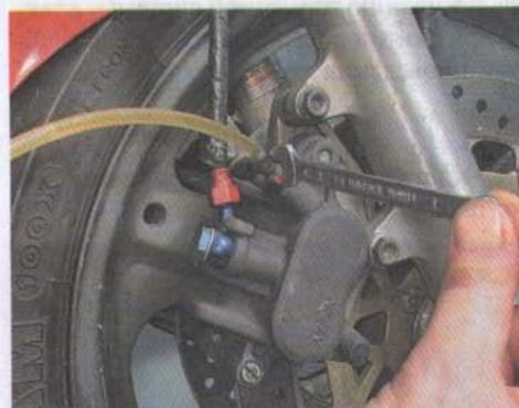
5. После того как рычаг переместился до упора, заворачиваем штуцер, затем отпускаем рычаг тормоза.
