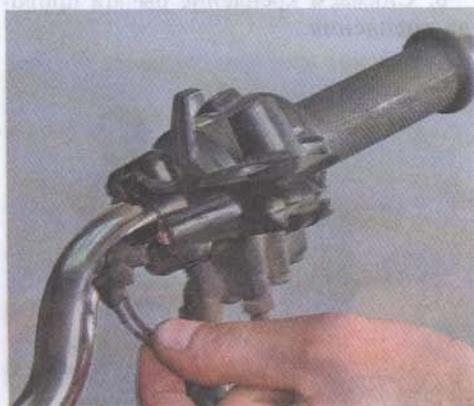
6. Ключом на 10 мм отворачиваем два болта крепления рычага.
