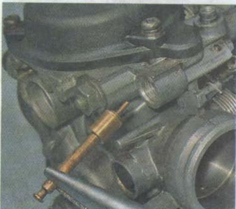
10. Крестовой отверткой отворачиваем три винта крепления крышки вакуумной мембраны.
