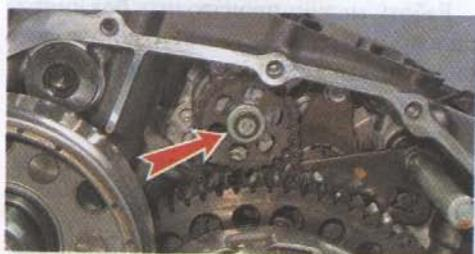
13. Снимаем с вала приводную звездочку масляного насоса.
