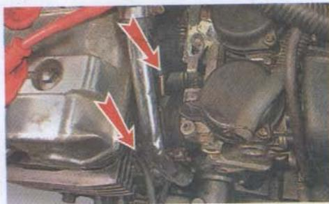
3. Запускаем двигатель, прогретый до рабочей температуры и выставляем винтом регулировки холостых оборотов частоту вращения коленчатого вала  $1200 \pm 100 \text{ мин}^{-1}$  (см. с. 66, «Система холостого хода. Регулировка оборотов»).
