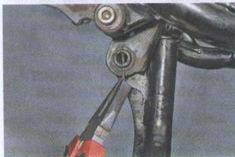
5. Снимаем шайбу оси.
