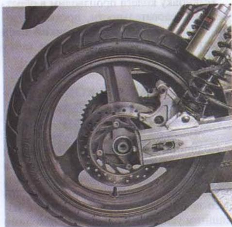
9. При снятии осей следим, чтобы не потерялись дистанционные шайбы колеса. Рекомендуется пометить расположение шайб для последующей сборки в правильной последовательности.
