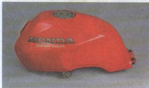
Заливная горловина закрывается крышкой, запирающейся ключом.
