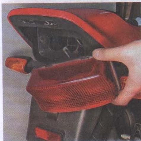
3. Снимаем лампы габаритного фонаря и сигнала торможения, поворачивая их цоколи против часовой стрелки.
