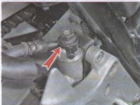
7. Снимаем болт в сборе с фитингом и двумя уплотнительными шайбами.
