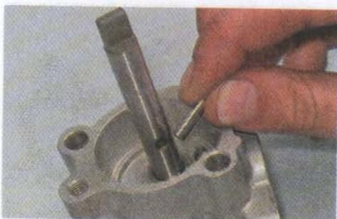
6. Снимаем с вала дистанционную шайбу ведущего ротора.
