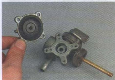
6. Извлекаем резиновую мембрану с клапаном из корпуса.
