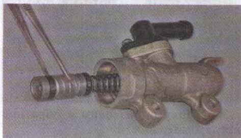
5. Если наблюдаются утечки тормозной жидкости в месте крепления штуцера шланга бачка тормозной жидкости, крестовой отверткой отворачиваем винт его крепления.
