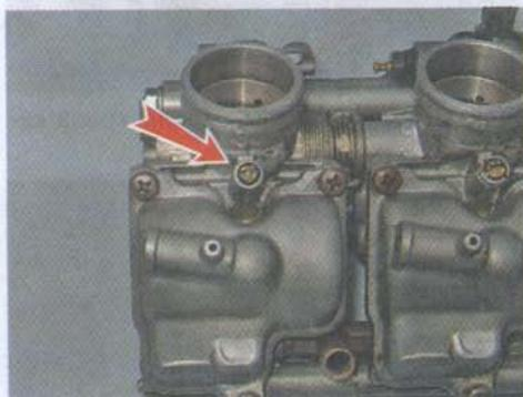
16. Извлекаем винт в сборе с пружиной, металлической шайбой и резиновым уплотнительным кольцом.
