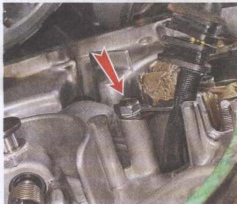
2. Шестигранным ключом на 5 мм отворачиваем четыре болта крепления статора к крышке.
