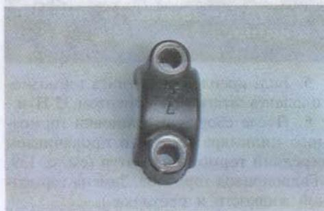
3. Для правильной установки цилиндра относительно руля на него нанесена контрольная точка, которая при установке должна находиться напротив стыка корпуса цилиндра и кронштейна.
