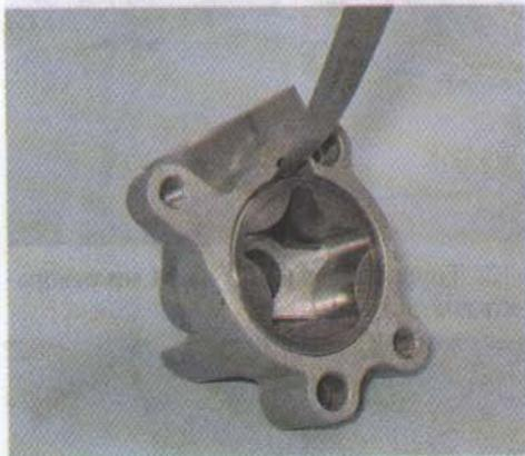
11. Устанавливаем в корпус оба ротора без вала. К плоскости корпуса ребром прикладываем металлическую линейку и поочередно замеряем зазоры между ней и ротором. Для удобства можно замерять зазоры, устанавливая роторы в корпус по отдельности. Разница в зазорах между линейкой и ротором будет равной зазору между роторами.
