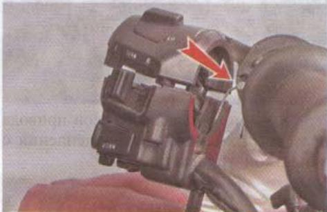
14. Ключом на 12 мм отворачиваем гайку оболочки троса пускового обогатителя.
