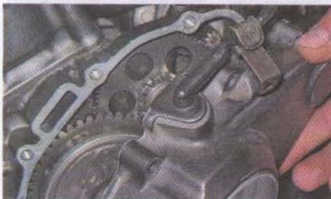
3. Удерживаем от проворачивания обгонную муфту, зафиксировав ее жалом отвертки, вставленным между зубьями шестерен и ключом на 14 мм отворачиваем болт крепления обгонной муфты к первичному валу коробки передач.
