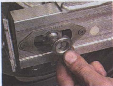
5. Сдвигаем колесо вперед до упора по направляющим маятника для ослабления натяжения цепи. Снимаем цепь с ведомой звездочки.
