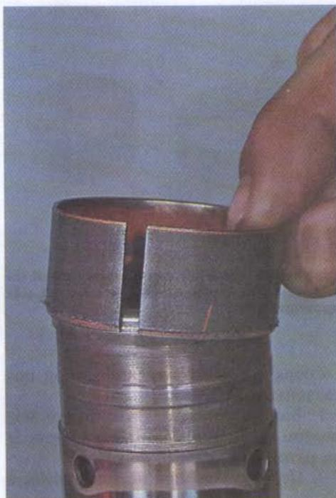
21. Осматриваем детали пера. На зеркале несущей трубы, особенно в зоне работы сальника и пыльника, не должно быть выработки, глубоких царапин, сколов или вздутий хрома. Проверяем геометрию трубы. Проще всего приложить к трубе длинную слесарную линейку и измерить зазоры между линейкой и поверхностью трубы, если таковые имеются. Если труба имеет деформацию более 3 мм на длине, а также при наличии любого из указанных повреждений она подлежит замене.
