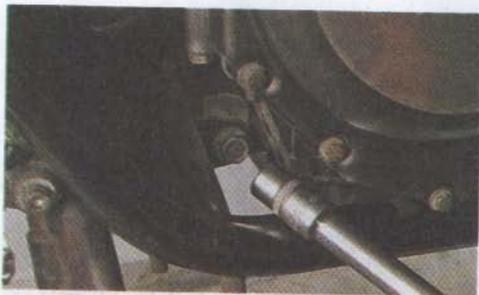
7. Аналогично п. 6 (см. выше) отворачиваем верхнюю заднюю шпильку крепления силового агрегата и извлекаем ее.
