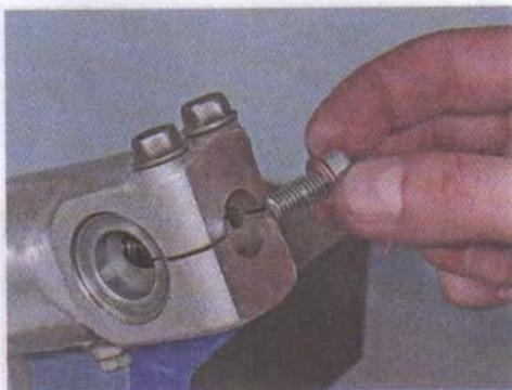
10. Тонкой шлицевой отверткой поддеваем пыльник пера.
