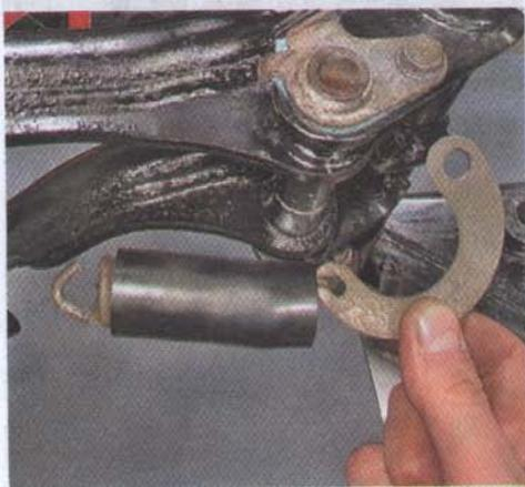
4. Плоскогубцами извлекаем шплинт оси подставки.
