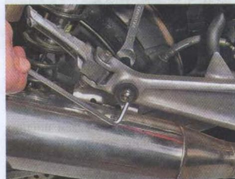
2. Аналогично п. 1 (см. выше, «Снятие левого кронштейна») отворачиваем болты крепления правого кронштейна и, придерживая, отводим немного на себя.
