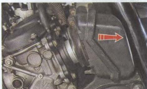
4. Крестовой отверткой ослабляем стяжные винты четырех хомутов впускного тракта.
