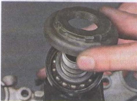
10. Снимаем верхнюю обойму подшипника.
