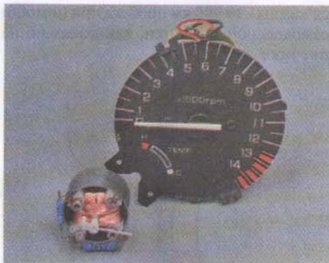
Тахометр и указатель температуры двигателя
