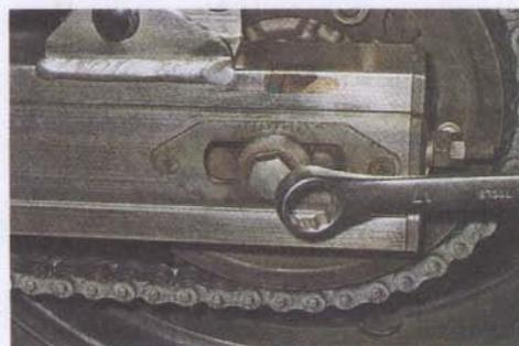
... ослабляем затяжку гайки оси накидным или торцовым ключом на 24 мм.
