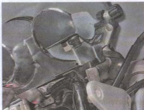
3. Крестовой отверткой отворачиваем трос от редуктора на оси переднего колеса.
