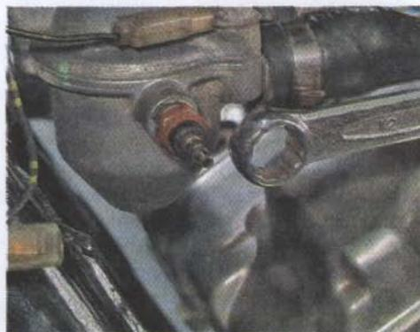
3. Извлекаем датчик из прилива в корпусе термостата.
