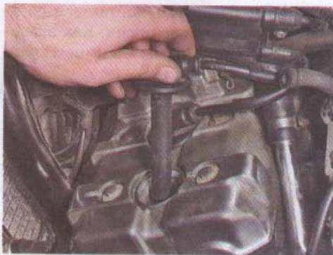
2. Трубчатым тонкостенным ключом или свечной головкой на 16 мм выворачиваем свечу и извлекаем ее из колодца.
