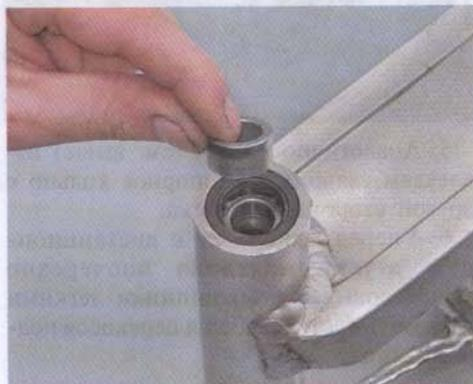
2. Поддеваем сальник шлицевой отверткой и выпрессовываем из посадочного отверстия.
