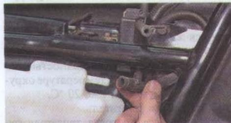
3. Пассатижами снимаем пружинный хомут и аналогично снимаем нижний патрубок.
