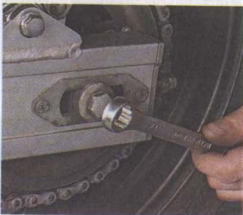
3. Ключом на 24 мм отворачиваем гайку оси.
