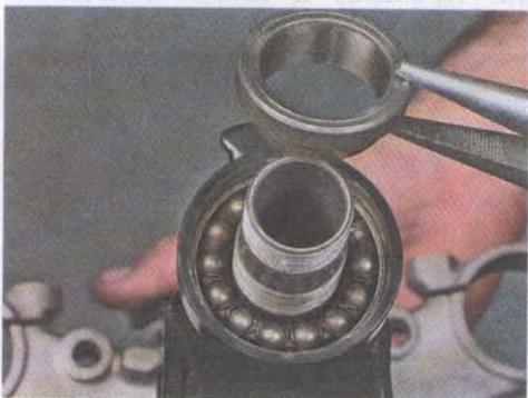
11. Извлекаем сепаратор с шариками.
