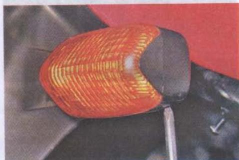
2. Снимаем рассеиватель в сборе с отражателем и лампой, сдвинув его вперед из пазов корпуса указателя поворота.
