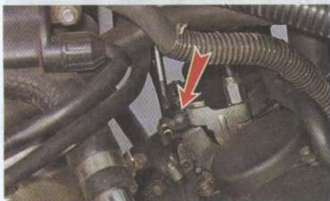
6. Извлекаем трос пускового обогатителя из держателя и отодвигаем его в сторону.
