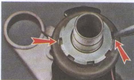
6. Радиусным ключом, входящим в комплект штатного набора инструментов мотоцикла, отворачиваем контргайку верхнего подшипника.
