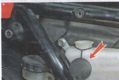
4. Подставляем под сливную пробку системы охлаждения емкость объемом не менее 3 л.
