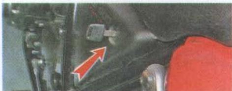
2. Удерживаем ключ в повернутом положении и поднимаем седло вверх за ремешок.
