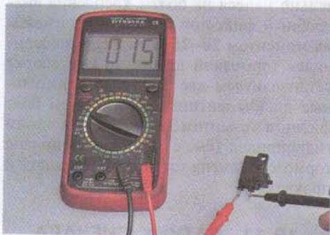
При отжатой кнопке датчика прибор должен показывать наличие проводимости. В противном случае датчик необходимо заменить.
