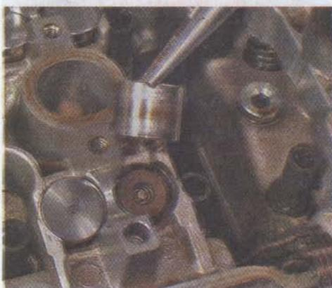
11. Смазываем плоскости толкателей моторным маслом.
