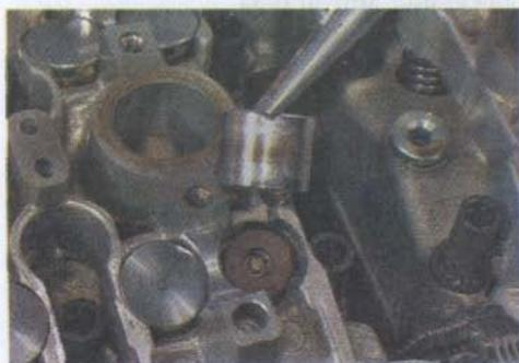
14. Чаще всего регулировочные шайбы тепловых зазоров клапанов прилипают ко дну толкателя на слое масла и снимаются вместе с ними.
