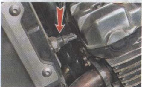
2. Накладным ключом на 24 мм отворачиваем датчик.
