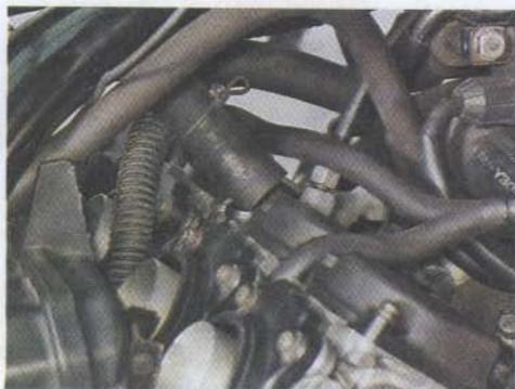
12. Ключом на 10 мм отворачиваем гайки крепления тросов привода дроссельных заслонок (на фото показан только трос привода, возвратный трос снят для наглядности).
