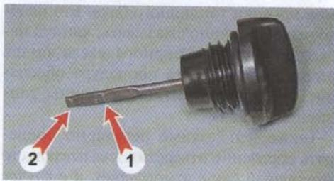
8. Если уровень масла ниже нижней риски на щупе, доливаем масло в двигатель. Разница объемов масла в двигателе, соответствующая нижней и верхней рискам на щупе составляет приблизительно 0,5 л.
