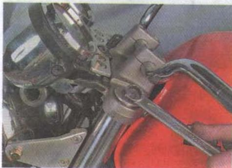
Для ускорения слива масла рекомендуется несколько раз нажать на верхнюю часть вилки, сжав пружины. Когда масло стечет, необходимо завернуть на место сливной болт моментом **7–8 Н·м** и залить в перо **100–150 мл** керосина или уайт-спирита для промывки. Сжимаем и разжимаем перо несколько раз, после чего сливаем промывочную жидкость, отвернув сливной болт. Сливаем промывочную жидкость. Заменяем медную шайбу, находящуюся под сливным болтом и заворачиваем болт.
