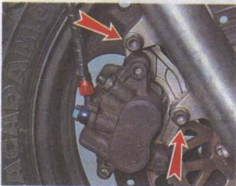
2. Снимаем суппорт, сдвигая его назад, в случае необходимости полного снятия ключом на 12 мм отворачиваем болт фитинга тормозного шланга.
