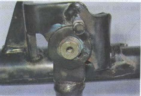
5. Вынимаем болт и снимаем боковой упор, сдвинув его вниз.
