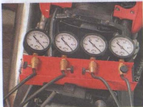
**Вакуумметр с четырьмя манометрами для синхронизации карбюраторов**
