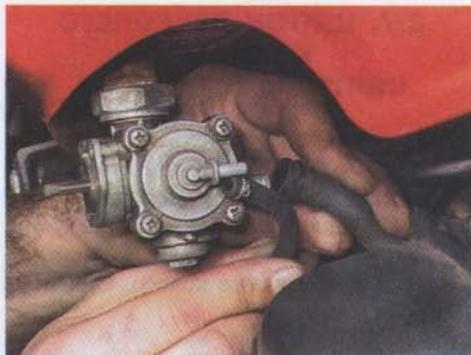
6. Если на мотоцикле установлен датчик уровня топлива, то разъединяем разъем проводов датчика уровня топлива (расположен под топливным баком слева).
