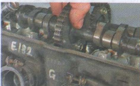
9. Снимаем цепь ГРМ со звездочки и вынимаем вал.
