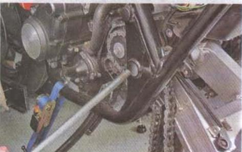
5. Вынимаем маятник из рамы мотоцикла.
