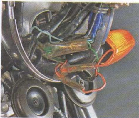
Для снятия заднего указателя поворота необходимо разъединить клеммные соединения сигнала, находящиеся под сиденьем.
