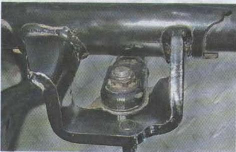
4. Ключом на 14 мм отворачиваем болт крепления упора.
