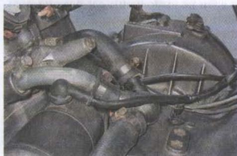
2. Ключом на 10 мм отворачиваем гайку положительного провода стартера и снимаем его.
