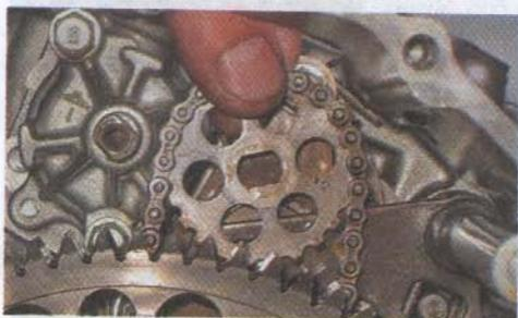
14. Извлекаем звездочку и подвязываем цепь отрезком проволоки или шнура, чтобы она не упала в картер.
