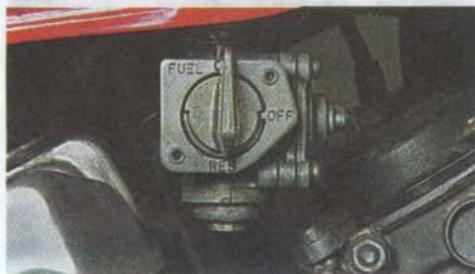
3. RES – резервный режим работы; переключение на него необходимо, когда в топливном баке остается около трех литров топлива.
