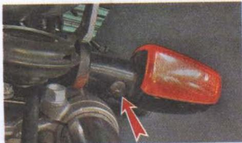
2. Снимаем указатель поворота в сборе, сдвинув его в сторону с кронштейна крепления, после чего извлекаем жгут проводов.
