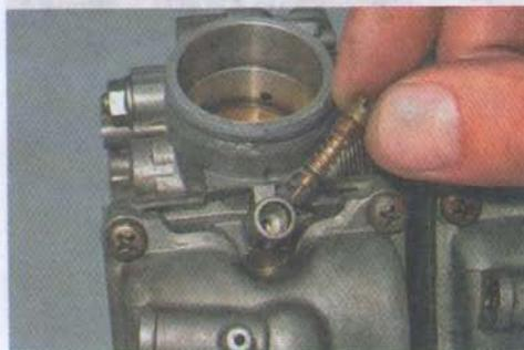
17. Осматриваем винт «качества». Если игла имеет деформацию или сломана, винт подлежит замене. Если имеются дефекты резинового уплотнительного кольца, оно также подлежит замене. Некачественное уплотнение иглы винта «качества» приведет к нарушению работы карбюратора и невозможности его настройки.
