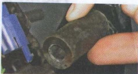
10. Удерживая ключом на 17 мм гайки передних болтов крепления двигателя, ключом на 14 мм отворачиваем болты.
