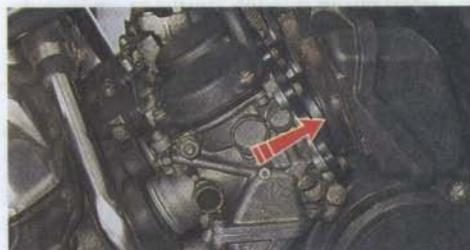
9. Смещаем планку карбюраторов вправо, чтобы получить доступ к атмосферным шлангам и тросу привода дроссельных заслонок.
