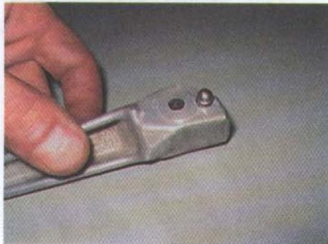
3. Укладываем на подножку стопорную пластину так, чтобы шарик оказался в отверстии пластины в положении, когда подножка откинута.
