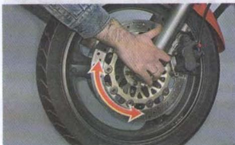
3. Пытаемся покачать вилку в направлении вверх-вниз, параллельно оси рулевой колонки. Любой люфт в данном направлении в рулевой колонке говорит о недостаточной затяжке подшипников рулевой колонки либо о выходе их из строя. Если люфт чувствуется в сопряжении подвижных и несущих труб перьев вилки, замены требуют направляющие вилки (см. с. 116, «Перья передней вилки. Проверка и замена сальников (разборка и сборка)»).
