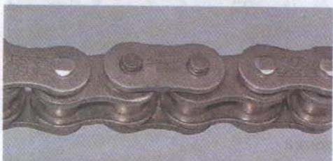
6. Переставными плоскогубцами обжимаем замковое звено до появления проточек на осях.
