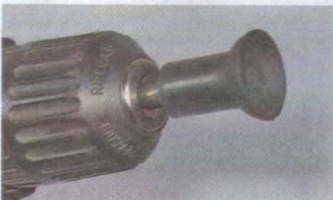
15. Присоска укрепляется в патроне дрели, шурупверта или просто на карандаше. Другой стороной присоска крепится к тарелке клапана, установленного на свое место клапана с нанесенной на кромку притирочной пастой.
