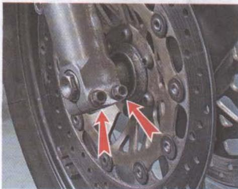
2. Торцовым ключом на 24 мм отворачиваем гайку оси.
