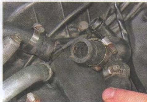
4. Ключом на 10 мм отворачиваем болт крепления патрубков системы охлаждения.
