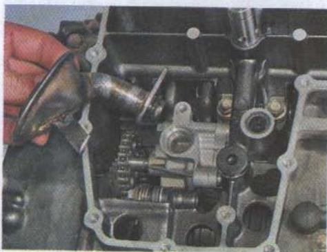
8. Очищаем сетку маслозаборника от осадка и грязи. Лучше всего это сделать, промыв ее в ацетоне или керосине и продув сжатым воздухом в направлении, обратном потоку масла.
