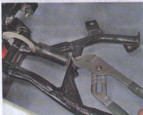
3. Снимаем пружину подставки.
