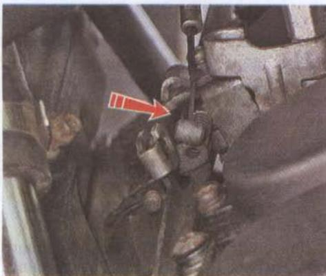
11. Крестовой отверткой отворачиваем два винта блока рулевых переключателей.
