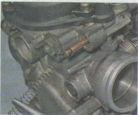
9. Извлекаем клапан обогатителя в сборе с тягой.
