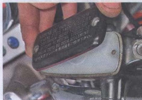
3. Снимаем пластину мембраны.
