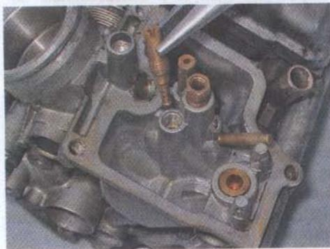
27. Накладным ключом на 7 мм выворачиваем распылительную трубку главной дозирующей системы и извлекаем ее.
