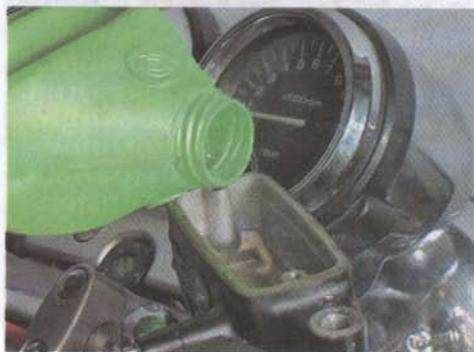
8. Когда из сливного штуцера пойдет свежая жидкость, штуцер необходимо затянуть. После его затягивания необходимо несколько раз нажать тормозной рычаг до появления сопротивления нажатия. После долива жидкости до верхней метки в смотровом окне, устанавливаем мембрану, пластину мембраны и крышку бачка. Заворачиваем два винта крышки, вытираем потеки тормозной жидкости ветошью.
