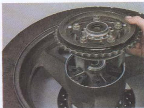
2. Извлекаем четыре демпфера из обоймы, поддев их для удобства снятия тонкой отверткой.
