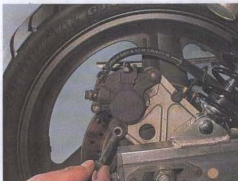
3. Поднимаем суппорт, как показано на фото, и шестигранным ключом на 5 мм отворачиваем направляющий штифт тормозных колодок.
