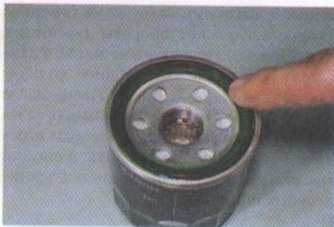
14. Наворачиваем фильтр на штуцер. Затягивать фильтр следует от руки (момент затяжки – 10 Н·м).
