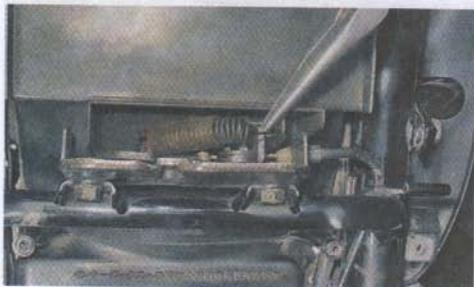
2. Извлекаем бобышку троса фиксатора из паза.
