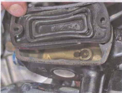
5. Внимательно осматриваем крышку бачка, пластину мембраны и мембрану на отсутствие повреждений. Перед установкой на место следует очистить их от грязи и остатков старой тормозной жидкости.
