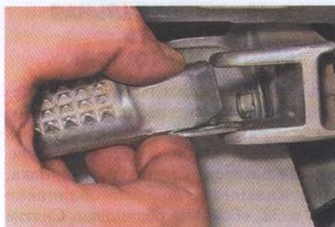
5. Вставляем в кронштейн предварительно смазанную пластичной смазкой ось, надеваем на нее шайбу и фиксируем шплинтом.
