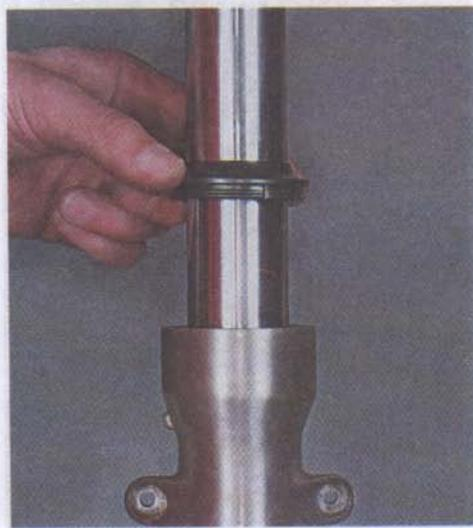
12. Той же отверткой поддеваем и извлекаем стопорное кольцо сальника.
