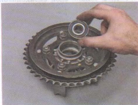
7. Еще раз проверяем подшипники на отсутствие люфтов и заеданий при вращении. Подшипники должны вращаться плавно и без излишних шумов.
