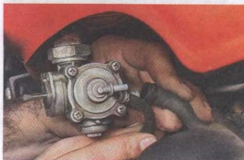
2. Ключом на 27 мм отворачиваем гайку крепления топливного крана от бака и снимаем кран.
