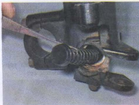
6. Осматриваем детали тормозного цилиндра. На манжетах не допускаются надрывы, трещины, они не должны быть деформированы. Кроме того, манжеты должны иметь достаточную гибкость. В противном случае вероятно возникновение утечек тормозной жидкости и
