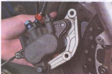
2. Шестигранным ключом на 5 мм отворачиваем направляющий штифт колодок и извлекаем его.
