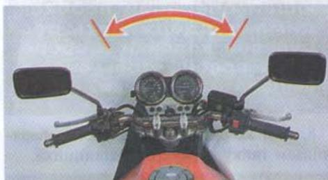
2. Взявшись за концы перьев вилки в нижней их части, пытаемся покачать вилку вперед-назад. Малейший люфт в рулевой колонке — повод проверить и отрегулировать затяжку подшипников или заменить их.
