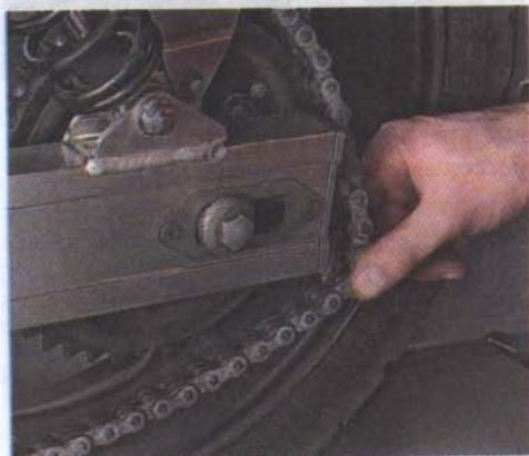
6. Легкими ударами резинового молотка (либо используя обычный молоток и деревянную проставку во избежание повреждения оси) выбиваем ось колеса.
