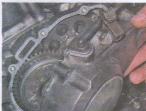
4. Ключом на 10 мм отворачиваем три болта крепления прерывателя.
