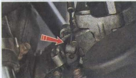
8. Сдвигаем планку карбюраторов назад, в сторону корпуса воздушного фильтра.
