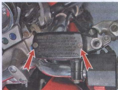
2. Снимаем крышку бачка.
