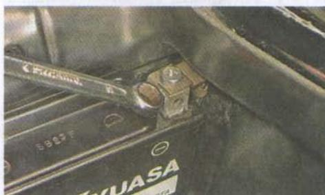
4. Снимаем изоляционную крышку положительного вывода аккумуляторной батареи, сдвигая ее вверх, после чего крестовой отверткой отворачиваем болт положительного вывода аккумуляторной батареи и отсоединяем провод.
