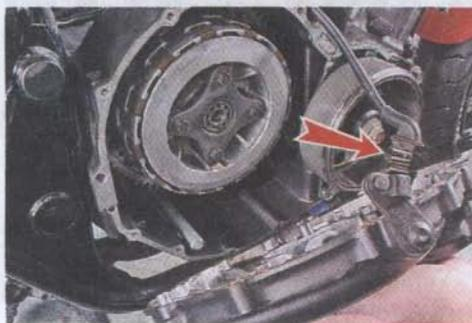
1. Ключом на 10 мм отворачиваем болт крепления проводов генератора.
