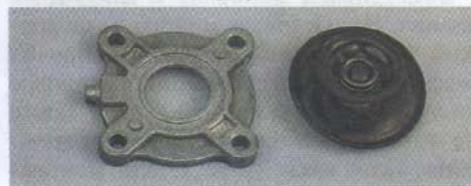
После разборки необходимо промыть все металлические детали крана очистителем карбюратора либо растворителем, чтобы удалить смоляные отложения.
