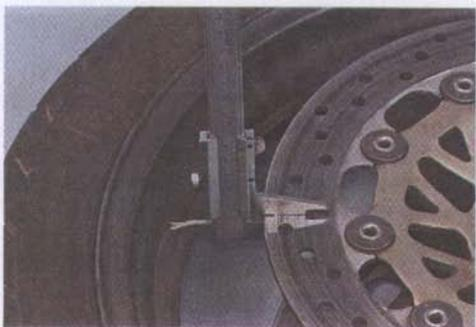
Измерить толщину рабочей поверхности диска можно при помощи штангенциркуля, не снимая колесо с мотоцикла.
