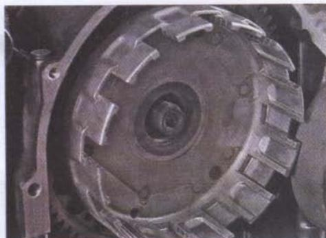
18. Снимаем с вала корзину и заменяем игольчатый подшипник (подшипник установлен на валу без натяга).
