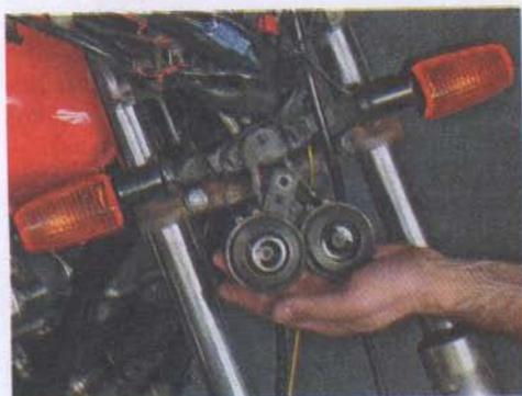
Регулировка тональности звука производится путем вращения регулировочного винта на тыльной стороне звукового сигнала. Звук должен быть громким и чистым, без каких-либо посторонних шумов. Второй звуковой сигнал регулируется аналогично.
