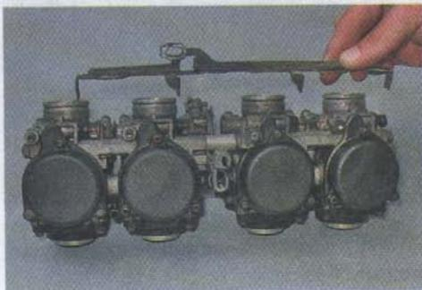
7. Накидным ключом на 10 мм отворачиваем корпус обогатителя и снимаем его.
