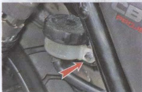
6. Накидным ключом на 12 мм отворачиваем болт фитинга тормозного шланга.
