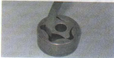
10. Измеряем радиальный зазор между ведомым ротором и корпусом насоса. Зазор должен находиться в пределах 0,15–0,22 мм.
