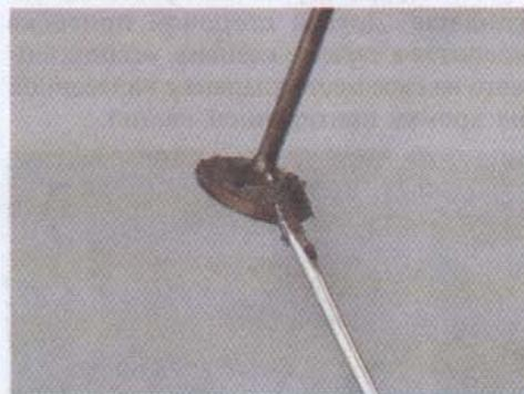
12. Устанавливаем клапан на свое место,жимаем инструментальную насадку в патрон дрели или шурупверта. Одной стороной надеваем трубку на насадку,
