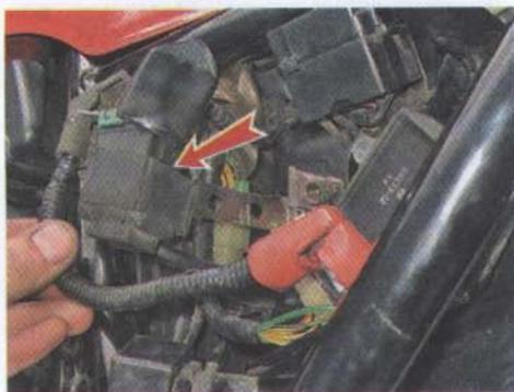
3. Извлекаем подседельную емкость из рамы мотоцикла, поворачивая ее влево и смещая назад.
