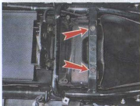
2. Ключом на 10 мм отворачиваем болты крепления рукояток пассажира и болты заднего крепления щитка заднего колеса.
