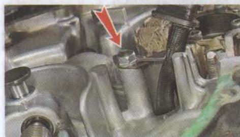
6. Если прокладка крышки приклеилась к плоскостям и порвалась, отчищаем остатки старой прокладки с привалочных плоскостей картера и крышки.
