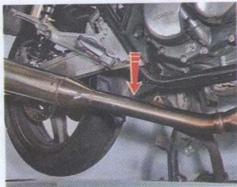
4. Сдвигаем ее вперед, выводя патрубки из головки блока цилиндров.
