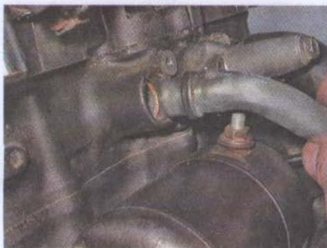
6. Ключом на 10 мм отворачиваем два болта крепления стартера, на одном из них закреплен отрицательный провод аккумуляторной батареи.
