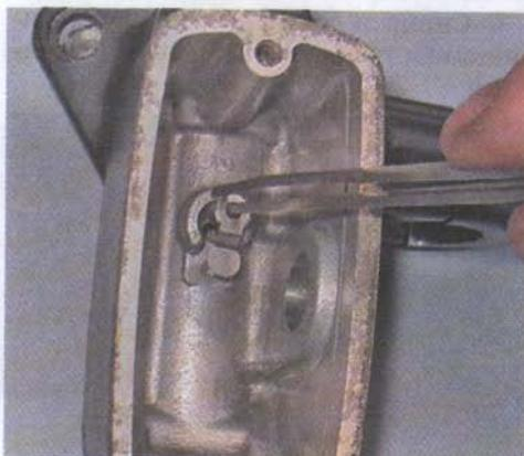
2. Аккуратно, чтобы не порвать, пинцетом снимаем пыльник поршня.
