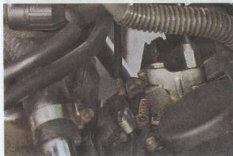
7. Сдвигаем бобышку троса в сторону и извлекаем трос.
