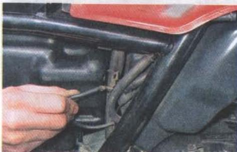
2. Снимаем с резиновых креплений реле указателей поворота и стартера.
