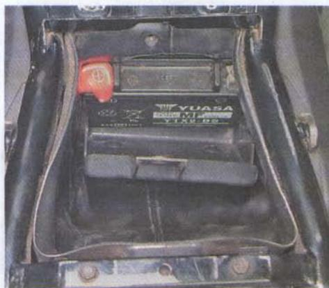
3. Ключом на 10 мм отворачиваем болт отрицательного вывода аккумуляторной батареи и отсоединяем провод.
