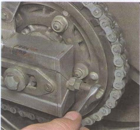
8. Заворачивая или отворачивая гайки регулировочных шпилек ключом на 14 мм, смещаем колесо вперед или назад в маятнике, тем самым увеличивая или ослабляя натяжение цепи.
