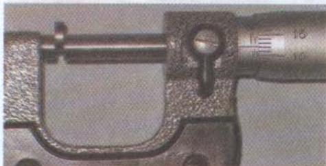
Вычисляем толщину новой шайбы по формуле  $A = B + (C - 0,15)$  – для впускных клапанов,  $A = B + (C - 0,22)$  – для выпускных клапанов, где  $A$  – толщина необходимой шайбы,  $B$  – толщина старой шайбы,  $C$  – измеренный тепловой зазор.
