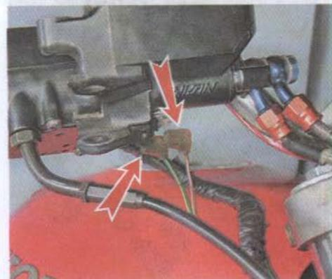
9. Накладным ключом на 8 мм отворачиваем два болта крепления тормозного цилиндра к рулю.
