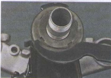
9. Снимаем гайку верхнего подшипника.
