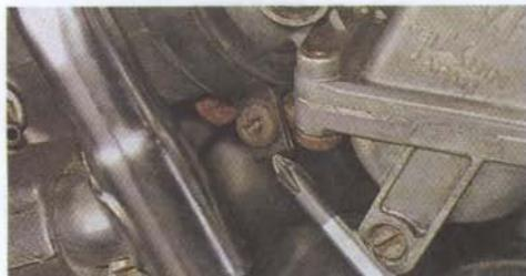
5. Ею же ослабляем винт крепления троса пускового обогатителя.
