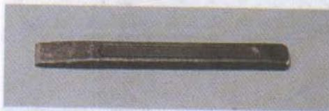
13. Монтажная лопатка. Желательно иметь набор из двух-трех лопаток разной длины, которые можно использовать как рычаги.
