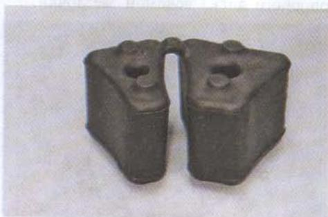
Установку и сборку демпферов производим в обратной последовательности, предварительно нанеся на резиновые элементы тонкий слой силиконовой смазки.
