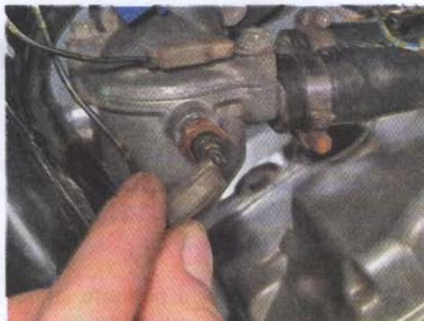
2. Накладным ключом на 12 мм отворачиваем датчик.
