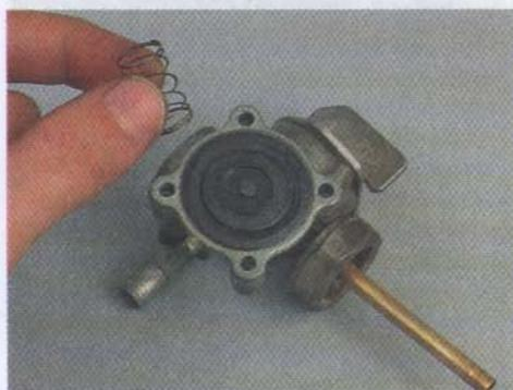
5. Аккуратно, чтобы не повредить резиновую мембрану, снимаем корпус мембраны в сборе с мембраной и запорным клапаном.
