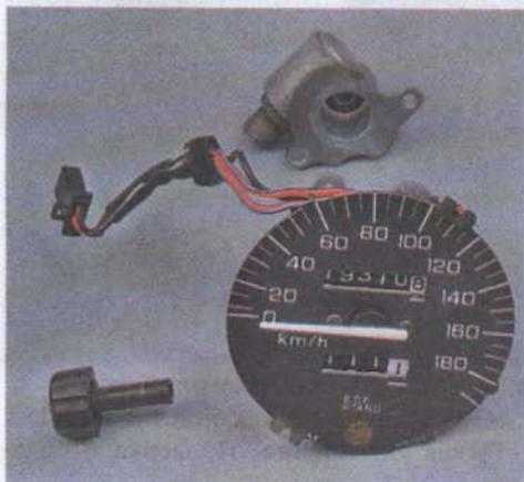
Спидометр и редуктор спидометра
