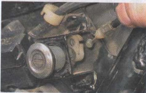
7. Извлекаем замок из посадочного отверстия на раме мотоцикла.
