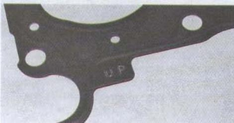
3. При установке прокладки метка UP должна располагаться сзади, по ходу движения мотоцикла.
