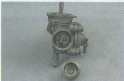
Необходимо тщательно промыть отстойник и внутренние полости крана очистителем карбюраторов, после чего продуть сжатым воздухом
