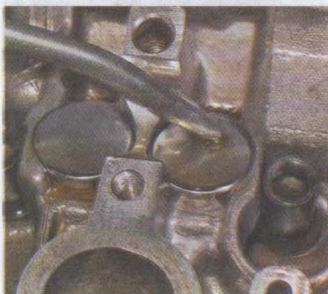
12. Выворачиваем заглушки правой крышки картера. Вращая коленчатый вал за болт генератора торцовым ключом на 14 мм по часовой стрелке, совмещаем
