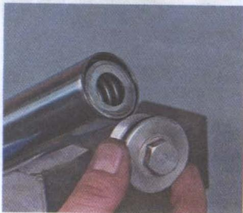
4. Вынимаем упорную шайбу
