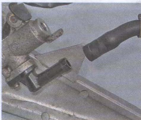
11. Пассатижами с узкими губками снимаем пружину датчика сигнала торможения сначала с педали, а затем — с самого датчика.
