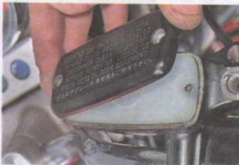
3. Снимаем пластину мембраны.
