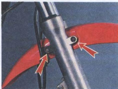
2. Повернув щиток, как показано на фото, снимаем его, сдвинув вперед и вниз.
