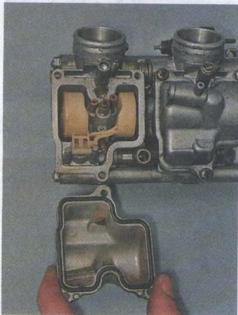
20. Пассатижами с узкими губками извлекаем ось поплавка.
