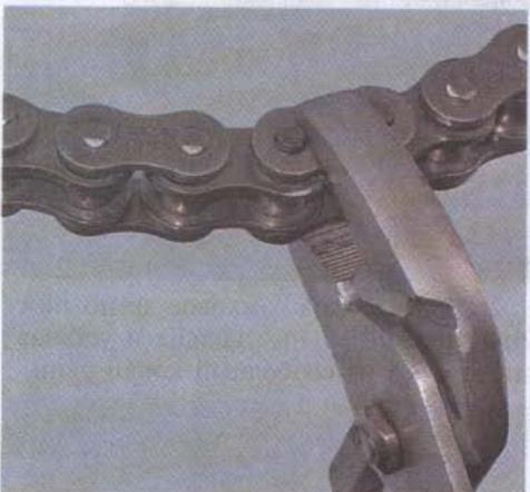
7. Устанавливаем фиксатор на замковое звено, так чтобы он вошел в проточки на осях и расположился, как показано на фото (стрелкой показано направление движения цепи).
