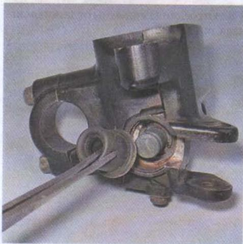
3. Специальными щипцами снимаем стопорное кольцо поршня.
