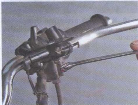
2. Шлицевой отверткой отворачиваем ось рычага.
