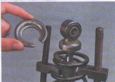
4. Снимаем пружину с амортизатора.
