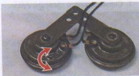
Проверить звуковой сигнал можно, подключив его напрямую проводами к заряженному аккумулятору. В случае отсутствия звука необходимо заменить неисправный сигнал.
