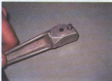
2. Укладываем на пружину смазанный шарик.
