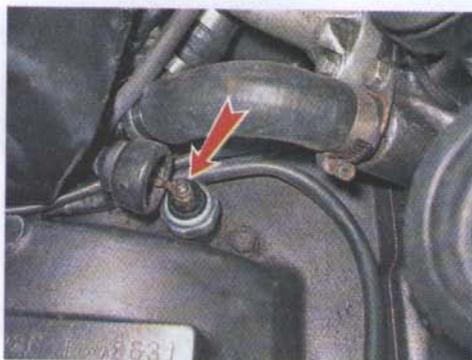
2. Торцовым ключом на 24 мм отворачиваем датчик.
