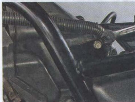
2. Сдвигаем корпус воздушного фильтра назад и извлекаем его из рамы, приподнимая вверх.
