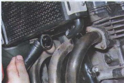
5. Отсоединяем разъем датчика включения вентилятора и разъем вентилятора.
