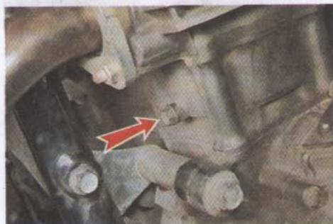
Левая сливная пробка блока цилиндров
