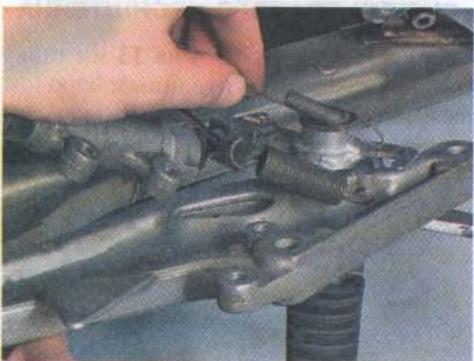
5. Плоскогубцами извлекаем шплицы оси штока главного тормозного цилиндра.
