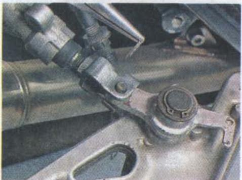
6. Извлекаем ось штока и снимаем левый кронштейн подножек.
