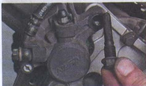
3. Снимаем суппорт, сдвигая его с диска назад и вверх, при необходимости полного снятия ключом на 12 мм отворачиваем болт фитинга тормозного шланга.
