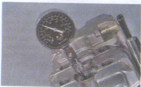
Полностью открываем дроссельные заслонки, повернув рукоятку управления на себя до упора. Проворачиваем коленчатый вал стартером в течение нескольких секунд и замеряем компрессию.
