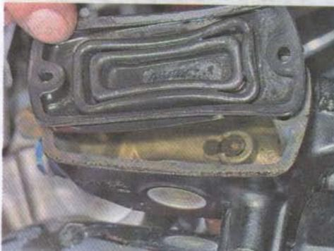
5. Шприцем или резиновой грушей удаляем из бачка тормозную жидкость.
