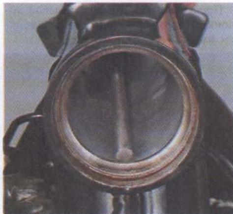
15. Осматриваем нижнюю обойму подшипника и в случае необходимости ее замены спрессовываем ее с оси, поддев тонкой шлицевой отверткой.
