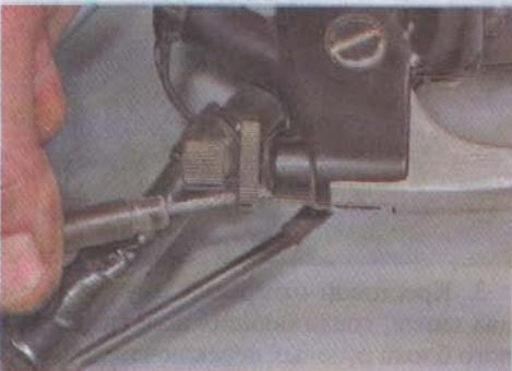
4. Извлекаем бобышку троса через прорезь в рычаге, сдвигая ее вниз и окончательно освобождаем трос привода сцепления.
