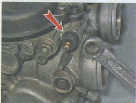
8. Снимаем возвратную пружину обогатителя.
