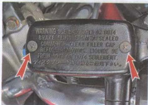
2. Снимаем крышку бачка тормозной жидкости.
