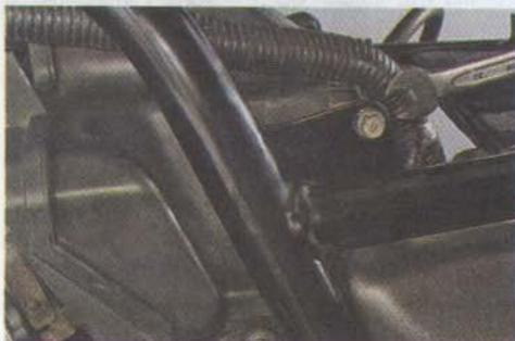
2. Крестовой отверткой ослабляем стяжные винты четырех хомутов воздушных патрубков.
