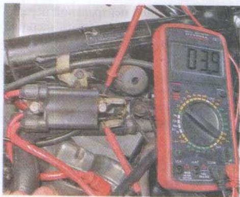
2. Омметром проверяем сопротивление вторичной обмотки катушки зажи-
