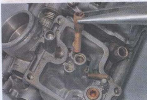
28. Крестовой отверткой отворачиваем четыре винта крепления корпуса отсечного клапана.
