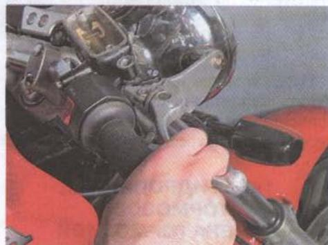
9. После начала слива тормозной жидкости, необходимо доливать в бачок свежую жидкость, во избежание попадания в систему воздуха.
