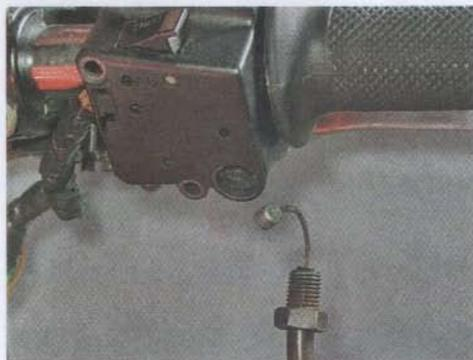
7. Ключом на 10 мм отворачиваем болт кронштейна катушки зажигания и извлекаем из-под него тросы привода дроссельных заслонок.
