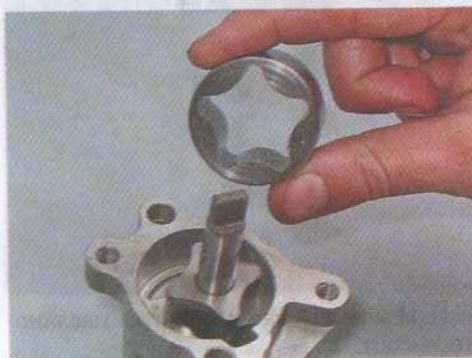
4. Снимаем с вала ведущий ротор.
