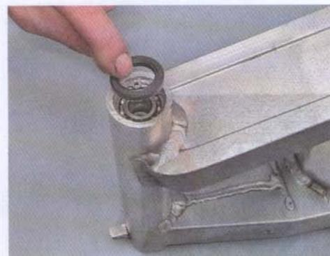
4. Специальными щипцами извлекаем стопорное кольцо подшипника.
