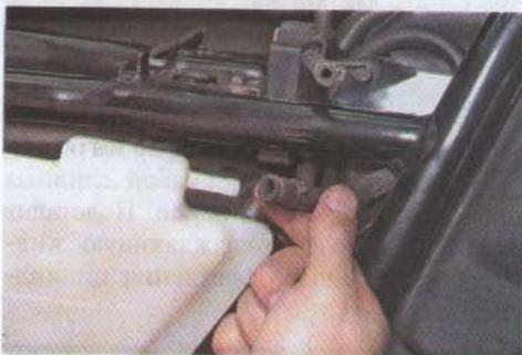
12. Ключом на 10 мм отворачиваем болт крепления расширительного бачка к раме мотоцикла.
