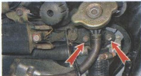
3. Отводим корпус термостата на шлангах в сторону. Ключом на 8 мм отворачиваем два болта крышки термостата.
