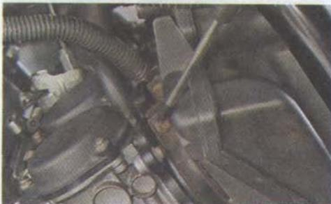
3. Сдвигаем корпус воздушного фильтра назад относительно планки карбюраторов.
