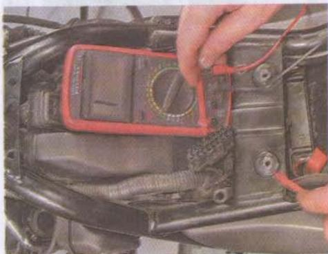
При включенной нейтральной передаче прибор должен показывать наличие проводимости.
