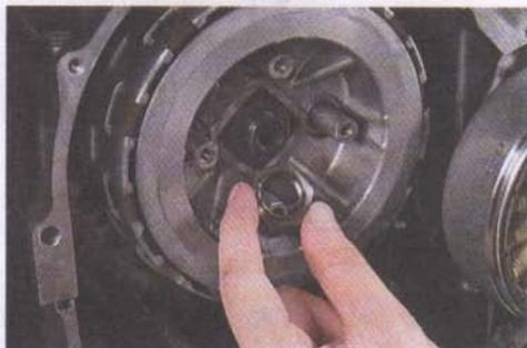
14. Снимаем упорный диск сцепления в сборе с двумя дистанционными шайбами (установлены со стороны зубчатки).
