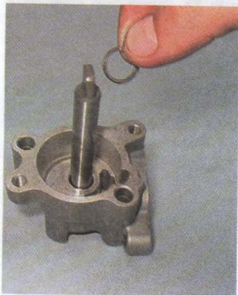
7. Извлекаем вал из корпуса масляного насоса.
