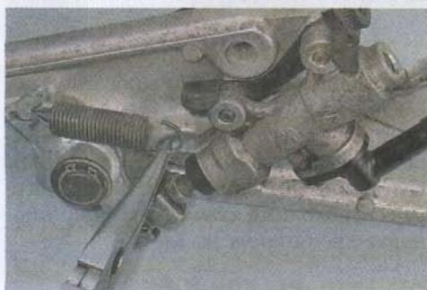
3. Тем же инструментом вынимаем шплинт тяги главного тормозного цилиндра.
