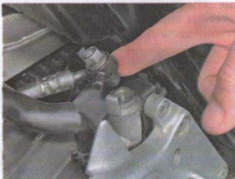
8. Снимаем с мотоцикла правый кронштейн подножек в сборе с тормозным цилиндром, подножками, педалью заднего тормоза и датчиком сигнала торможения (см. с. 37, «Кронштейны подножек. Снятие и установка»).
