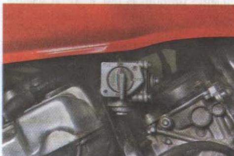
1. ON – основное положение топливного крана при работающем двигателе. Во время стоянки кран автоматически закрывается, при запуске двигателя разрежение из впускного коллектора первого цилиндра передается по трубке к мембране топливного крана, и она открывает путь топливу.
