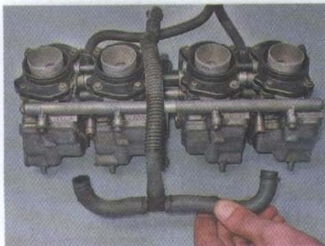
3. Пассатижами с узкими губками разжимаем пружинные хомуты, сдвигаем их вверх и снимаем со штуцеров две трубки сообщения поплавковых камер с атмосферой.
