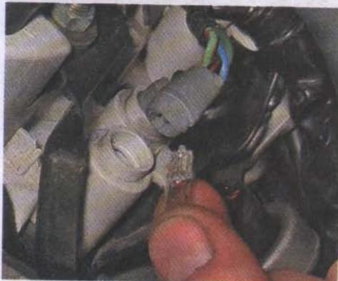
В панели приборов мотоцикла используются бесцокольные лампы 12 В, 1 Вт. Сборку панели приборов производим в обратной последовательности.
