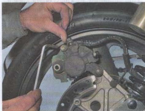
4. Извлекаем направляющий штифт, после чего тормозные колодки выдвигаем из суппорта вниз.
