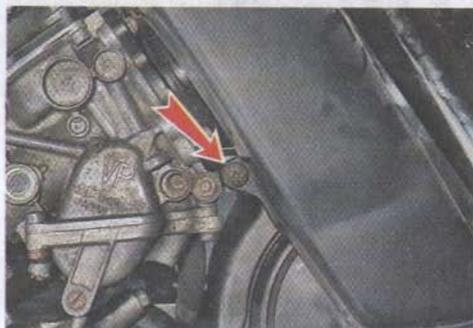
2. Ключом на 8 мм отворачиваем три винта крепления крышки воздушного фильтра.
