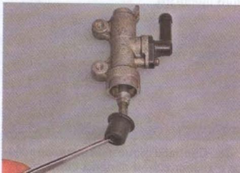
2. Специальными щипцами снимаем стопорное кольцо штока.
