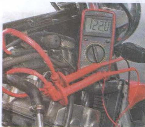
гания между наконечниками проводов высокого напряжения. Номинальное сопротивление вторичной обмотки с проводами должно быть в пределах 23–27 кОм.
