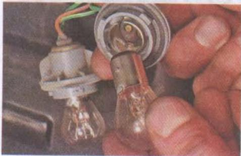
В заднем фонаре используются две лампы 12 В, 21+5 Вт.
