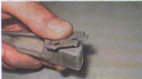
4. Устанавливаем подножку в кронштейн, удерживая стопорную пластину от смещения. Подножку следует устанавливать в откиннутом положении.
