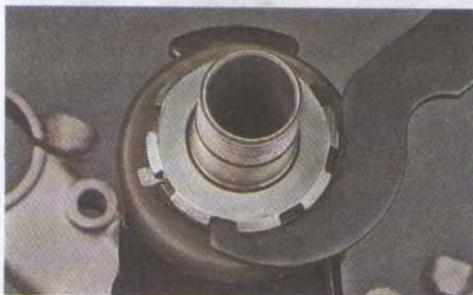
7. Снимаем шайбу.
