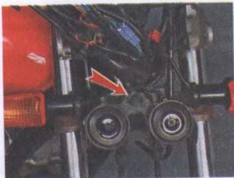
3. Снимаем сигналы.
