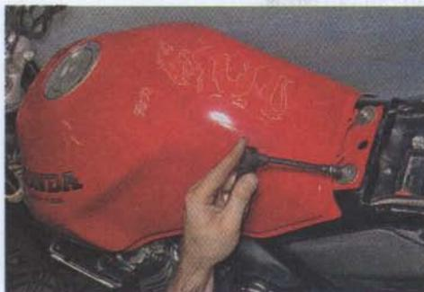
4. Приподнимаем заднюю часть бака и, разжав пружинные хомуты, отсоединяем от штуцеров трубки соединения полости бака с атмосферой и дренажа.
