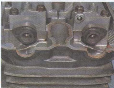
15. Смазываем моторным маслом опорные шейки распределительных валов.
