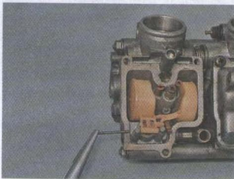
21. Вынимаем поплавок в сборе с запорной иглой.
