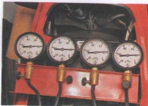
4. Проверяем разрежение на рабочих оборотах ( $4000-6000 \text{ мин}^{-1}$ ), вращая рукоятку управления дроссельными заслонками. Двигатель должен быстро набирать и сбрасывать обороты. После этой процедуры синхронизацию карбюраторов можно считать законченной.
