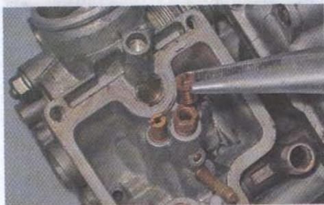
25. Шлицевой отверткой выворачиваем жиклер системы холостого хода.
