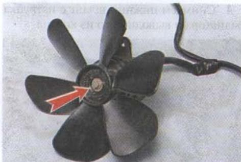
5. Снимаем крыльчатку вентилятора с вала электродвигателя.
