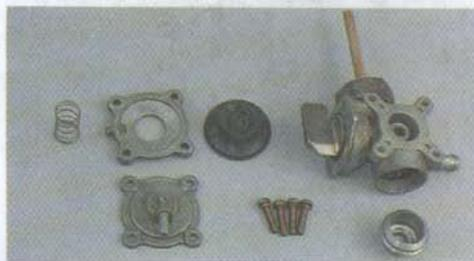
Детали топливного крана
