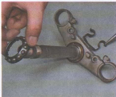
14. Используя выколотку подходящего размера выпрессовываем из рулевой колонки обойму нижнего подшипника.
