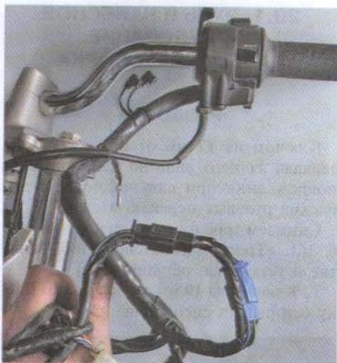
10. Крестовой отверткой отворачиваем два винта блока рулевых переключателей.
