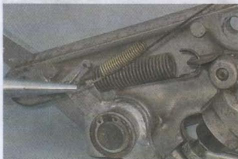
2. Плоскогубцами снимаем возвратную пружину педали заднего тормоза.
