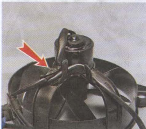
2. Крестовой отверткой отворачиваем три винта крепления электродвигателя.
