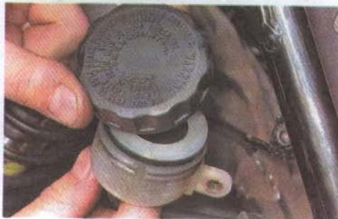
2. Снимаем пластину мембраны.
