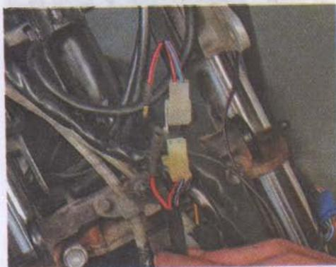
2. Поворачиваем ключ в замке в положение «все включено» и проверяем сопротивление при помощи омметра. Во включенном положении выключателя омметр покажет сопротивление 10–30 Ом.
